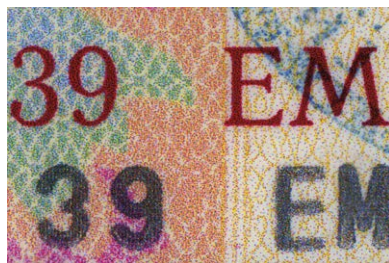
— Fot. 21. Numer dokumentu i elementy szaty graficznej w podrobionym rosyjskim prawie jazdy, nadrukowane przy użyciu drukarki atramentowej —
