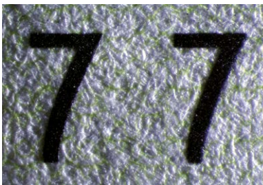
— Fot. 12. Fragment podrobionej rosyjskiej Zielonej Karty. Część numeru wydrukowana drukarką laserową —
