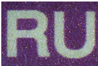
— Fot. 23. Imitacja nadruku farbą zmiennooptyczną w podrobionym rosyjskim prawie jazdy —
