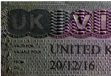
— Fot. 36. Przetłoczenia w podrobionej wizji brytyjskiej wykonane dla zaimitowania wkłęsłodruku —
