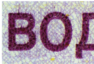
— Fot. 24. Element graficzny w podrobionym rosyjskim prawie jazdy nadrukowany farbą zmiennooptyczną. Widoczne w tle elementy giloszu nadrukowano przy wykorzystaniu drukarki atramentowej —
