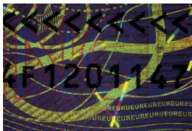
— Fot. 39. Nadruki fluorescencyjne w UV w autentycznej wizji brytyjskiej —
