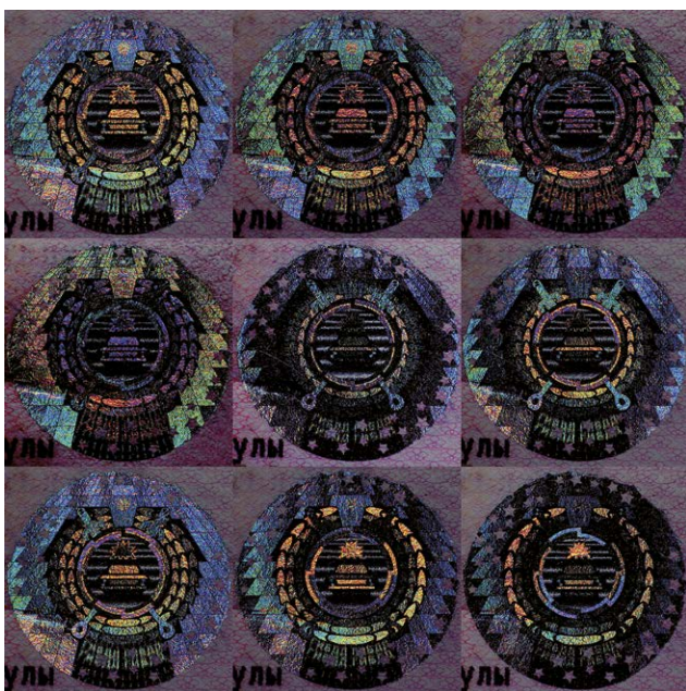
— Fot. 8. Imitacja zmiennooptycznego elementu dyfrakcyjnego w podrobionym rosyjskim dowodzie rejestracyjnym —
