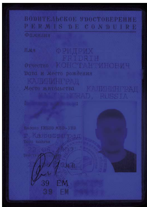
— Fot. 18. Intensywna fluorescencja podłoża podrobionego rosyjskiego prawa jazdy —
