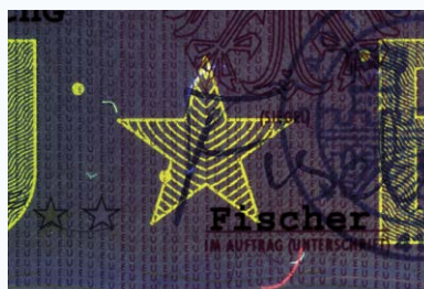
— Fot. 57. Nadruki włókien i broków w podrobionych niemieckich dokumentach pobytowych. Ten sam kształt i topografia nadrukowanych imitacji —
