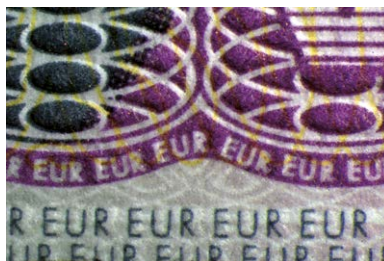
— Fot. 34. Nadruk elementów graficznych wykonany drukiem płaskim w podrobionej wizie brytyjskiej —
