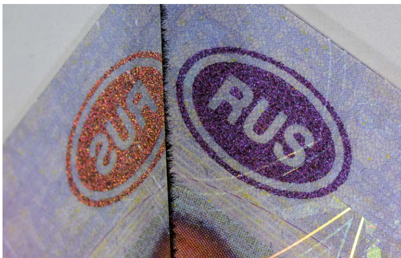
— Fot. 26. Element graficzny w podrobionym rosyjskim prawie jazdy nadrukowany farbą zmiennooptyczną. Widoczne w tle elementy giloszu nadrukowano techniką druku płaskiego —
