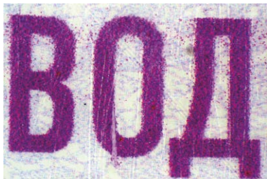
— Fot. 22. Elementy tła giloszowego w podrobionym rosyjskim prawie jazdy wydrukowane z wykorzystaniem drukarki atramentowej —
