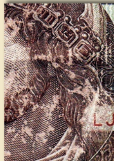
Fot. 9. Pranie w palce – banknot testowy bez powłoki
