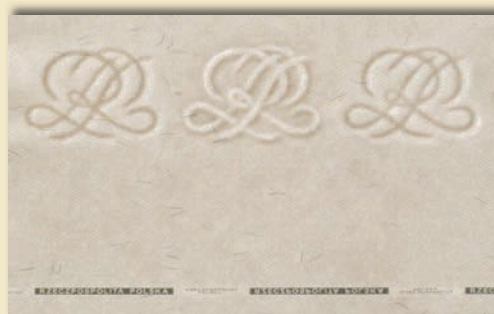
Fot. 7. Papier na stronę personalizowaną paszportu polskiego z pozytywno-negatywową nitką zabezpieczającą
