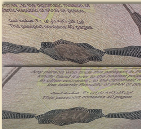
Fot. 6. Efekt kątowy na pierwszej wyklejce paszportu
