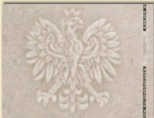
Fot. 5. Papier na strony wizowe paszportu polskiego z umiejscowionym wielotonowym znakiem wodnym oraz pozytywno-negatywową nitką zabezpieczającą
