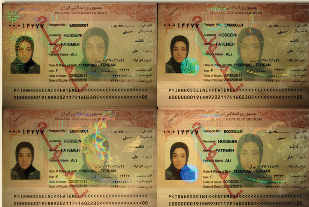
Fot. 11. Transparentna folia holograficzna zabezpieczająca dane właściciela w starszym wzorze paszportu 9
