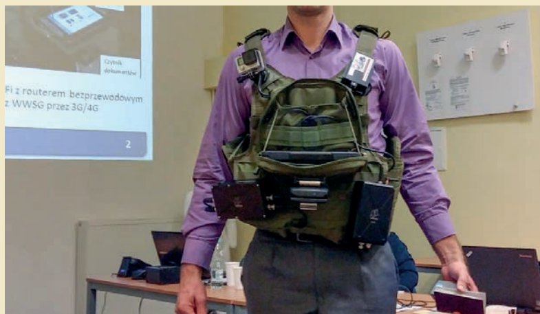
Ryc. 7. Zestaw mobilny z kamizelką (wykonany przez firmę MLabs) wraz z czytnikiem dokumentów oraz kartą mikroprocesorową (wyprodukowaną i dostarczoną przez PWPW S.A.) – wygląd rzeczywisty
