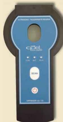
Ryc. 11. Wersja mobilna prototypu czytnika ultradźwiękowego firmy OPTEL
