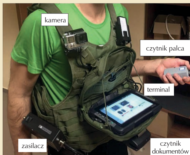
Ryc. 8. Zestaw mobilny z kamizelką (wykonany przez firmę MLabs) wraz z czytnikiem dokumentów (wybrany przez PWPW S.A.) – wygląd rzeczywisty
