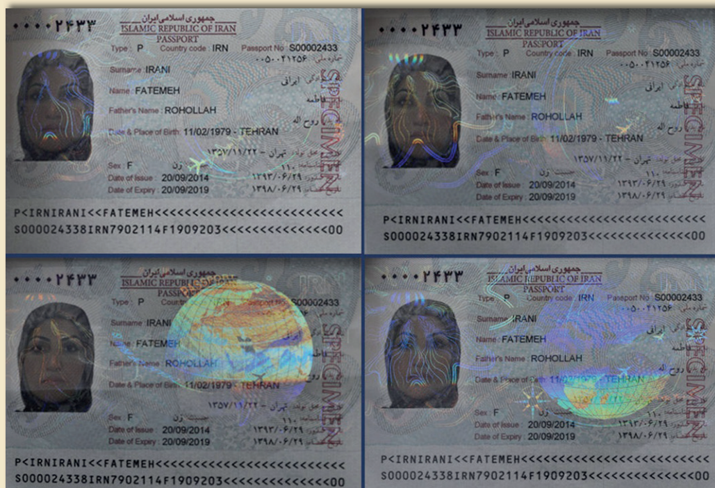
Fot. 12. Transparentna folia holograficzna zabezpieczająca dane właściciela zamieszczona w nowszym dokumencie 10
